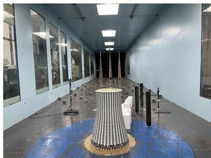
图 9 有干扰工况试验照片
