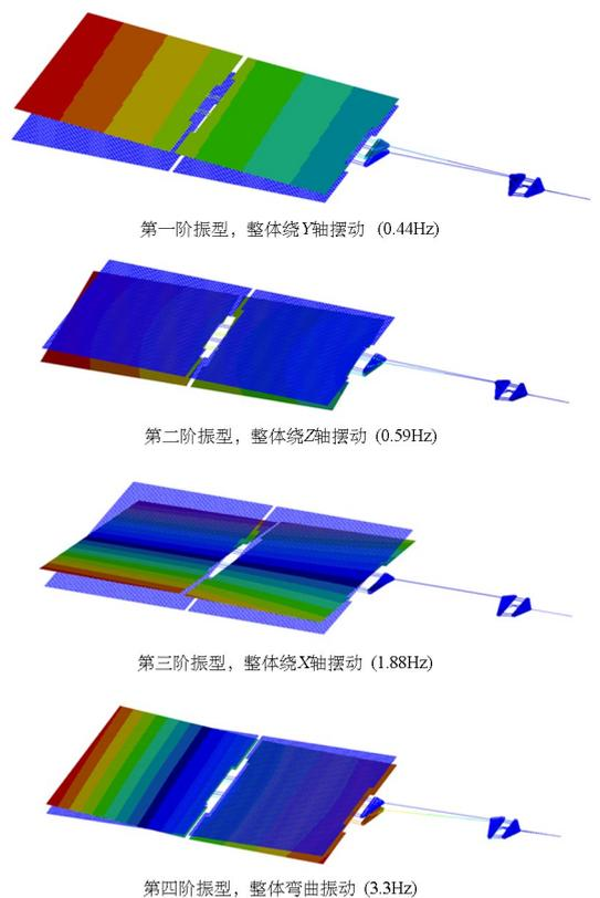
第一阶振型,整体绕Y轴摆动 (0.44Hz)
