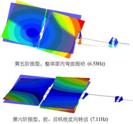
图4 太阳帆板前六阶模态振型图
