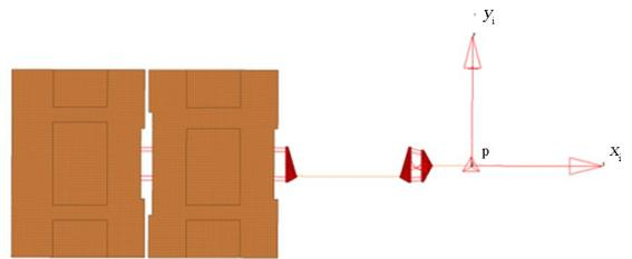
图 3 太阳帆板离散化网格模型
