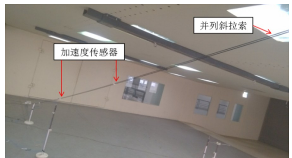
图 3 安装在风洞中的并列索模型
