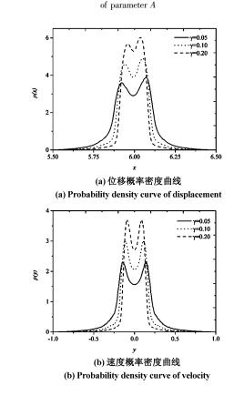
图 4 参数  $\gamma$  取不同值时的稳态响应概率密度 Fig. 4 Probability density of stationary response for different values of parameter  $\gamma$
