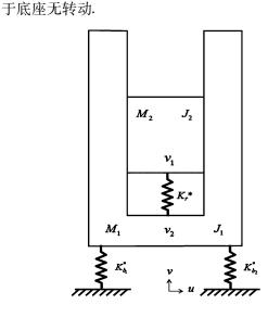
图 1 含滞迟缓冲器的螺栓法兰连接结构
