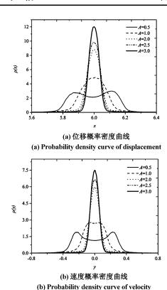
图 3 参数 A 取不同值时的稳态响应概率密度 Probability density of stationary response for different values
