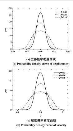
图 5 参数 β 取不同值时的稳态响应概率密度
