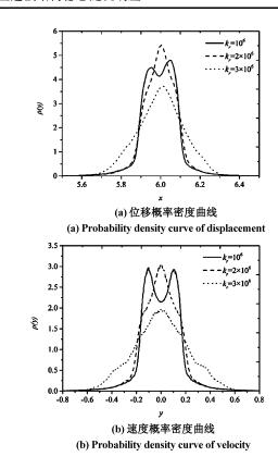
图 6 参数 k<sub>r</sub> 取不同值时的稳态响应概率密度
